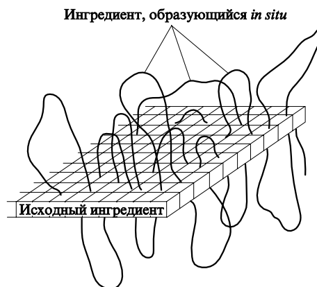
Рис. 19. Схема взаимопроникновения цепей в композициях, полученных полимеризацией in situ .
